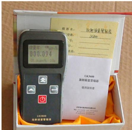
Ce compteur Geiger portable de grande fiabilité permet de mesurer la radioactivité entre 0 et 5 mSv/h (5 milli Sievert par heure).
